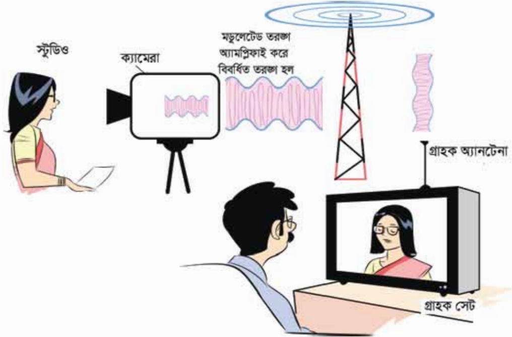
চিত্র 13.14: টেলিভিশন সম্প্রচার প্রক্রিয়া
