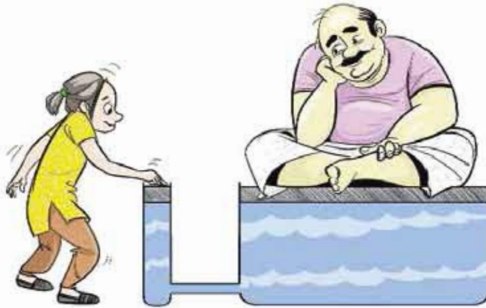
চিত্র 5.16: হাইড্রোলিক প্রেসে চাপ দিয়ে একটি মানুষকে উপরে তোলা।
