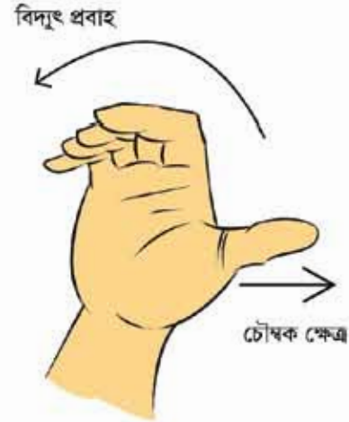
চিত্র 12.06: সুপের ভেতর দিয়ে বিদ্যুৎ প্রবাহ করলে ডান হাতের নিয়ম ব্যবহার করে।
