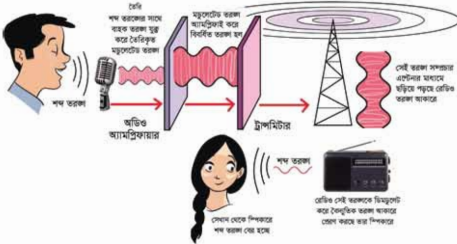
চিত্র 13.12: রেডিও সম্প্রচার প্রক্রিয়া।
