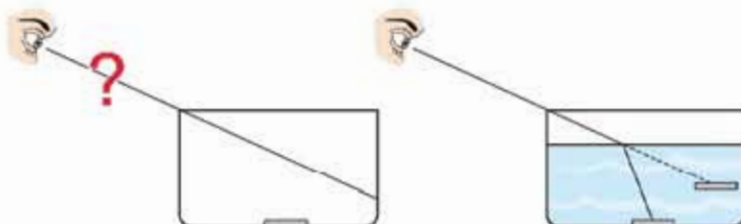
চিত্র 9.03: পানি ও কাচের তেতর আলোর প্রতিসরণ।
