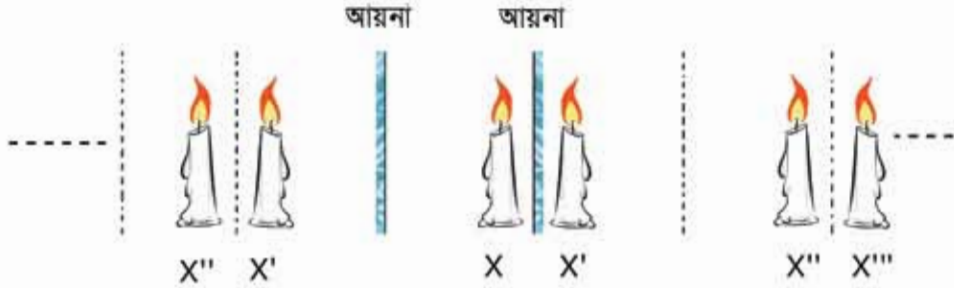
চিত্র ৪.০৪: দুটি সমান্তরাল আয়নার মাঝখানে একটি মোমবাতি x রাখা হলে তার প্রতিবিম্ব x' এবং x' প্রতিবিম্বের প্রতিবিম্ব x'' , x''' ... তৈরি হতে থাকে।
